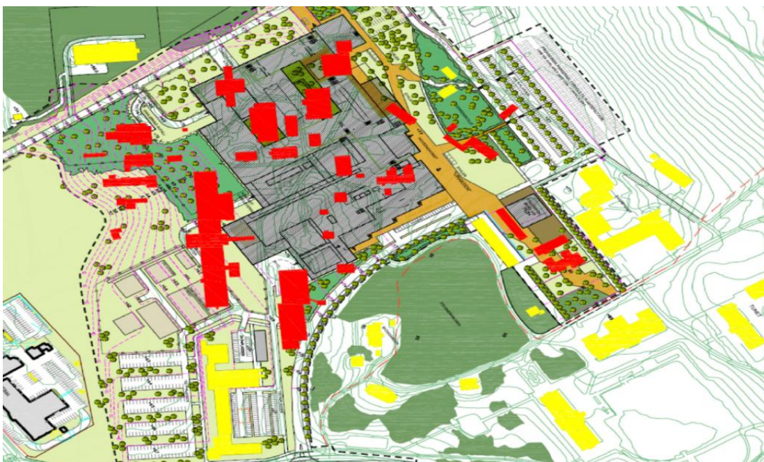
Figur 5-8: Oversikt over lokaler som må rives for å gi plass (rødt) til veterinærmiljøene på Ås, samt hvilke bygninger som skal bevares (gult).
