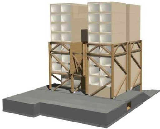
Figur 1-4 Modulkonstruksjon. Kilde: SWECO (2014)
